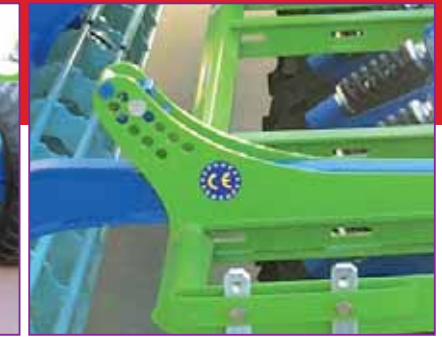
Control de profundidad de disco o brazos. Depth control by disc or arm Rouleau avec contrôle de profondeur
