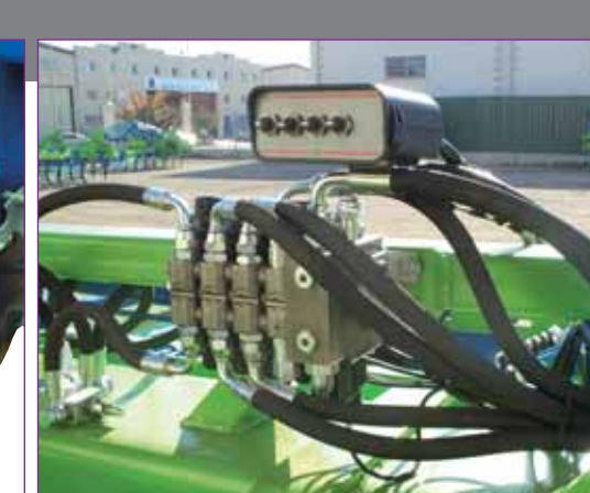
Equipo de mandos independientes (Opcional en STANDARD y de serie en STAR) Independent computer control (optional on the standard model and included on the Star model) Boîtier de commande (équipement optionnel dans les modèles standard et de série dans les modèles star)
