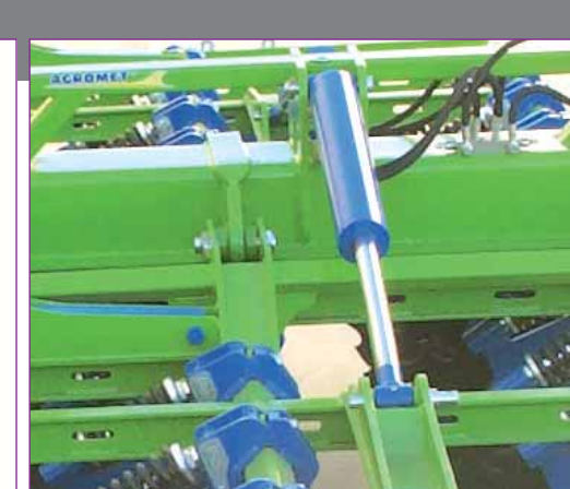
Detalle de plegado vertical. Vertical folding detail Détail du repliage hydraulique
